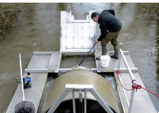
Les passe-pièges fonctionnent continuellement et sont vérifiées toutes les 30 minutes.
